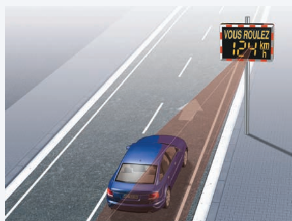
Exemple d'utilisation d'un cinémomètre en fonctionnement.
